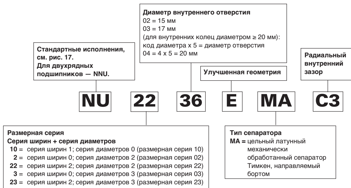
Рис. 16. Номенклатура радиальных цилиндрических роликовых подшипников метрической серии по стандарту ISO.
