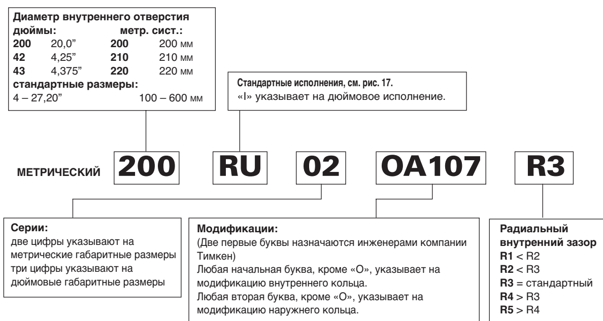
Рис. 18. Номенклатура радиальных цилиндрических роликовых подшипников по стандарту ABMA.
