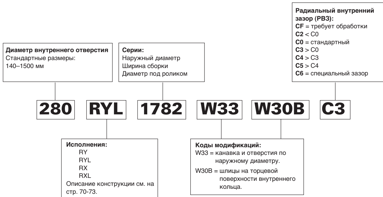
Рис. 20. Номенклатура четырехрядных цилиндрических роликовых подшипников.
