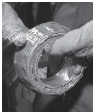
Рис. 14. Пластичная смазка позволяет легко заправить подшипник вручную.
