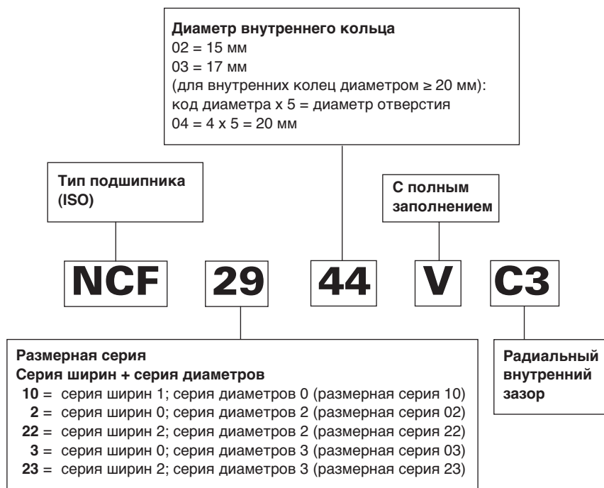
Рис. 19. Номенклатура цилиндрических роликовых подшипников с полным заполнением (NCF).
