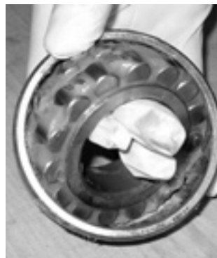
Рис. 21. Пластичная смазка позволяет легко заправить подшипник вручную.
